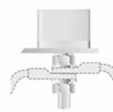
Perno expuesto para conectar dos terminales
