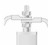
Perno expuesto para conectar dos terminales
